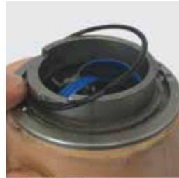
Einbauen des geschmierten O-Rings.
